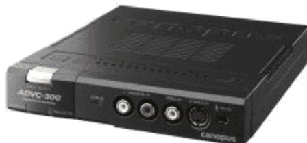
ビデオ装置からの出力でコンポーネント出力があれば、アナログ-DV コンバータも当然コンポーネント入力を持っている方が画質が良い。コンポーネントがなければ S 端子、これもなければコンポジット入力で接続する。
